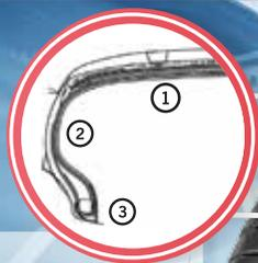
Nouvelle construction de carcasse plus légère pour une baisse de la résistance au roulement
